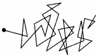
FIGURA 5.19 Recorrido de una sola molécula de gas. Cada cambio de dirección representa una colisión con otra molécula.
