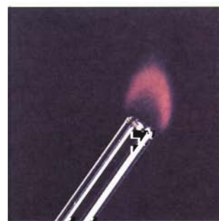
El hidrógeno se quema en presencia del aire para formar agua.
