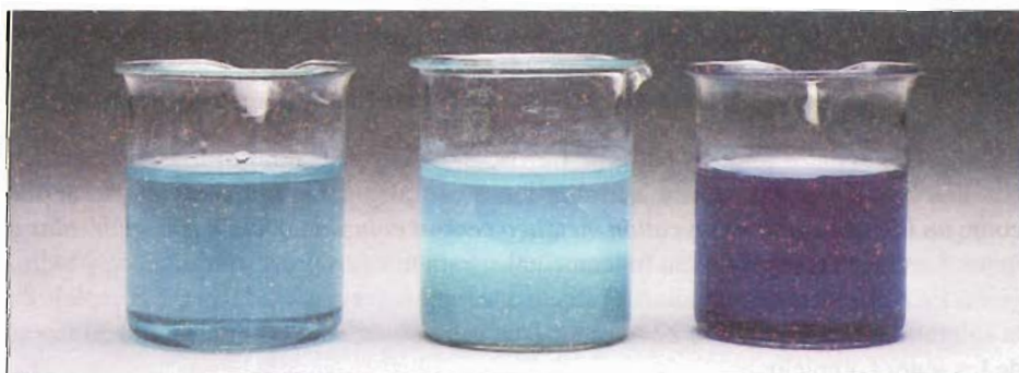
FIGURA 16.10 Izquierda: Una disolución acuosa de sulfato de cobre (II). Centro: Después de añadir unas gotas de una disolución acuosa concentrada de amoníaco, se forma un precipitado azul tenue de \text{Cu}(\text{OH})_2 . Derecha: Al añadir más disolución concentrada de amoníaco, el precipitado de \text{Cu}(\text{OH})_2 se disuelve y se forma el ion complejo \text{Cu}(\text{NH}_3)_4^{2+} de color azul oscuro.
