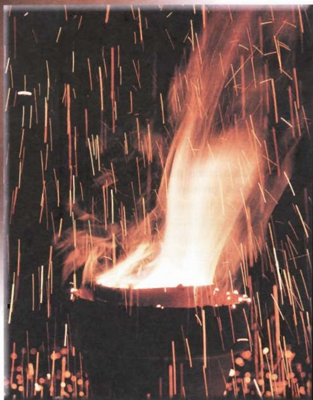
El calor generado en una reacción termita se utiliza para soldar el acero y el hierro.
