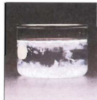
Precipitado formado por la reacción entre K_3PO_4(ac) y Ca(NO_3)_2(ac) .
