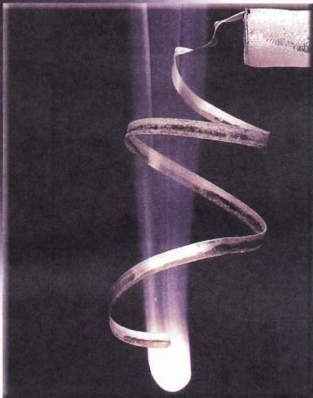
Magnesio quemándose en aire para formar óxido de magnesio ( MgO ) y nitruro de magnesio ( Mg_3N_2 ).
