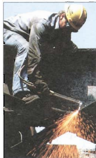
La temperatura de la flama de un soplete de oxiacetileno es muy alta ( 3000^{\circ}\text{C} ) y se utiliza para soldar metales.
