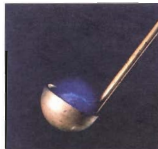
El azufre se quema en el aire para formar \text{SO}_2 .
