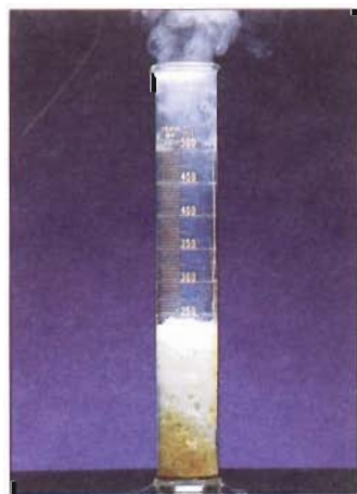
FIGURA 13.19 La descomposición del peróxido de hidrógeno está catalizada por el ion yoduro. Se agregaron unas cuantas gotas de un jabón líquido a la disolución para exagerar el desprendimiento del oxígeno gaseoso. (Parte de los iones yoduro se oxidan a yodo molecular, que reacciona con los iones yoduro para formar el ion triyoduro \text{I}_3^- , que es de color café.)
