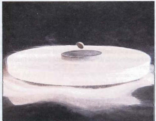
Levitación de un imán sobre un superconductor de alta temperatura sumergido en nitrógeno líquido.
