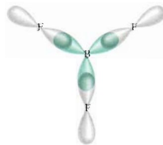
FIGURA 10.13 Los orbitales híbridos sp^2 del boro se solapan con los orbitales 2p del flúor. La molécula de BF_3 es plana y todos los ángulos FBF son de 120^\circ .
