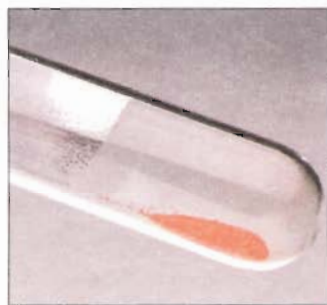
Al calentar el HgO se descompone y forma Hg y O 2 .
