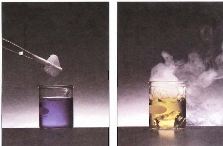
FIGURA 15.9 (Izquierda) Un vaso con agua al cual se le han agregado unas gotas del indicador azul de bromotimol. (Derecha) A medida que se agrega hielo seco al agua, el \text{CO}_2 reacciona para formar ácido carbónico, que vuelve ácida la disolución y cambia el color azul a amarillo.
