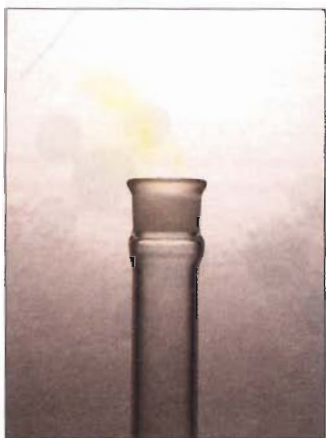
El \text{N}_2\text{O}_5 se descompone para formar \text{NO}_2 (de color café).
