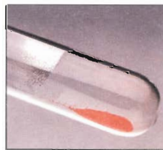
Cuando el \text{HgO} se calienta, se descompone para formar \text{Hg} y \text{O}_2 .
